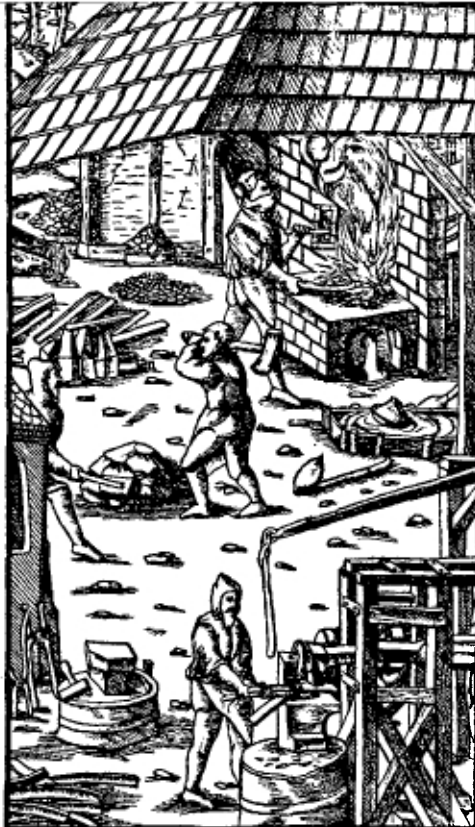
Afb.: Uit 'De Re Metalica' van G. Agricola 1556. In de late middeleeuwen gebruikten de smeden op dat moment technieken die toen al meer dan 2000 jaar oud waren. Op de achtergrond is een smid erts in de oven aan het smelten. Daarvoor zijn twee mannen ruw ijzer uit de oven aan het smeden. Op de voorgrond staat een smid te smeden aan een toen al hoog ontwikkelde mechanische hamer.
